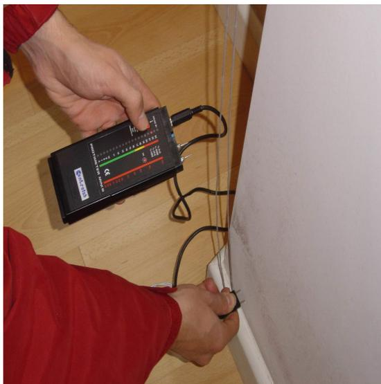
Fig. 1 - Medidor de humidade superficial.
