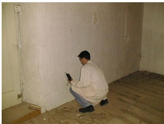
Fig. 2 - Medição da humidade numa parede de uma construção antiga.
